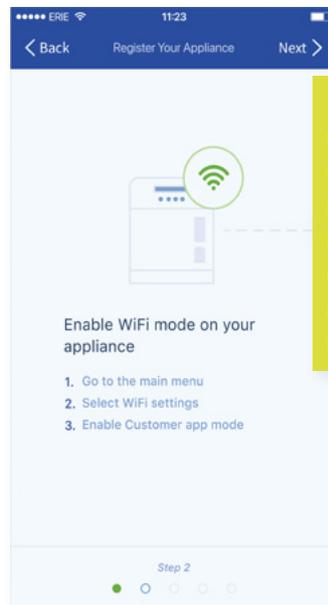
En la primera puesta en servicio, el descalcificador se encontrará automáticamente en **modo de configuración**. Para ajustar manualmente el modo Wi-Fi del dispositivo en **Configuración**, consulte la sección "Panel de control electrónico".
