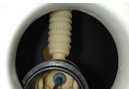
4.Schritt: Verteilerröhre in Verteilerkopf montieren, dabei Verteilerkopf mit Montagehilfe festhalten
