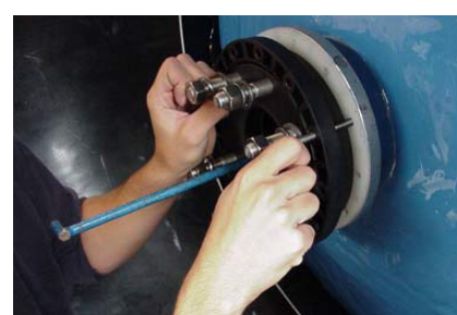
6.Schritt: Zur Montage des Verteilersystems auf den Flansch den hinteren Flansch verwenden. Montagehilfe entfernen
