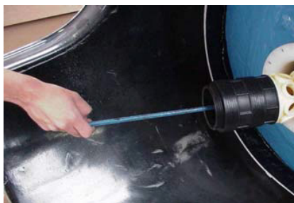
2.Schritt: Montierte Einzelteile mit der Montagehilfe I-WR03-LA in den Behälter einbringen
