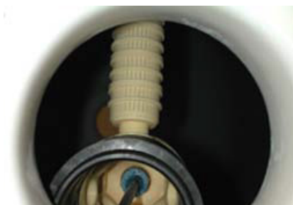
Paso 4: Atornille todos los laterales al cubo mientras continúa sujetando la extensión.
