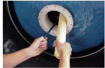
Paso 3: Coloque el montaje en el interior del depósito para montar los laterales.
