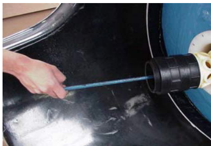
Fase 2: I pezzi mostrati nella fase 1 sono assemblati (all'esterno del serbatoio) e inseriti nel serbatoio attraverso l'estensione I-WR03-LA.
