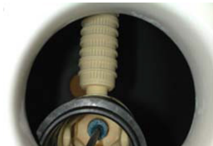
Stap 4: Schroef alle dwarsleidingen in de hub terwijl u de extensie nog vasthoudt.
