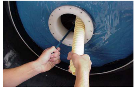
Stap 3: Plaats de gemonteerde assemblage in de tank om de verdeelarmen aan te brengen.
