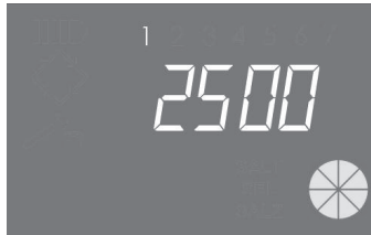
"In Betrieb"-Status – Mengenanzeige
