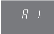
Départ en régénération immédiat
