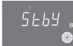
Im Regenerationsstatus – Anzeige des Standby-Status
