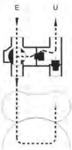
Automatische bypass tijdens regeneratie. Klep gaat automatisch open en laat onbehandeld water door
