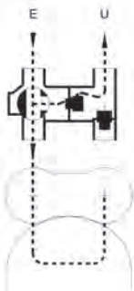
Bypass automatico rigenerazione. Valvola
