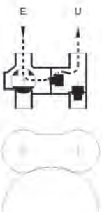
Automatische bypass Systeem afgesloten
