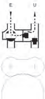
Bypass automatico Posizione di sezionamento impianto
