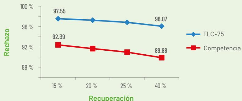
Condiciones del ensayo: membranas de O.I. de 75 galones al día, 3.5 bar de presión de entrada, 1000 ppm de TDS, agua descalcificada.
