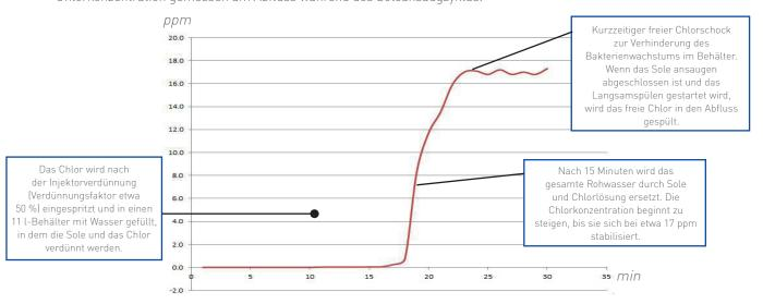
Die Chlorerzeugung stabilisiert sich nach ca. 22 Minuten bei einem Durchschnittswert von 17 ppm freiem CL2.
